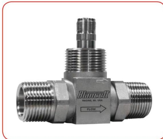
стрелки на корпусе реальному направлению потока. Для наилучшей производительности необходимо обеспечивать прямые участки трубопровода длиной минимум 10хДУ и 5хДУ соответственно до и после расходомера.
