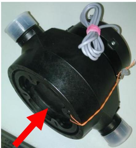
Рисунок 3 - Место нанесения знака поверки.
