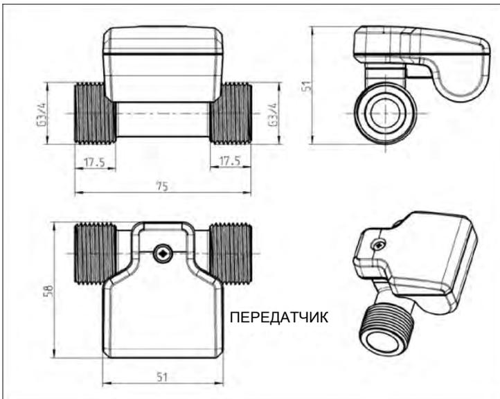
Беспроводная система, состоящая из передатчика и приемника (здесь показан передатчик для расходомера Vision 3000)
