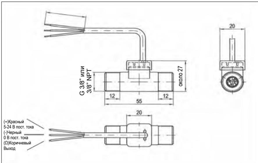
Пример: Vision 2000 с круглым кабелем 3 x AWG 24
