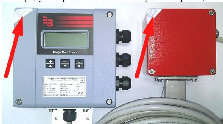
Рисунок 2 - Место пломбирования расходомера
